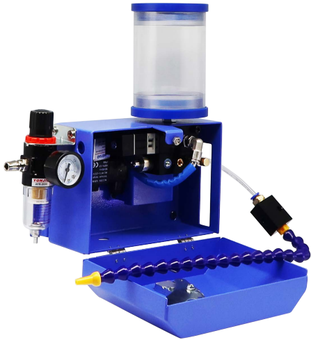
图4：带外壳的单泵输出系统
