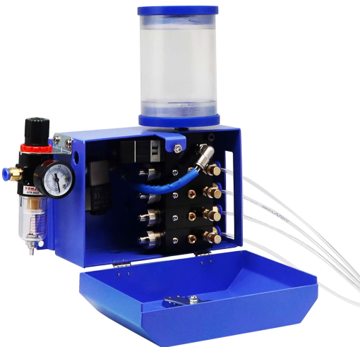
图5：带外壳的多泵输出系统
